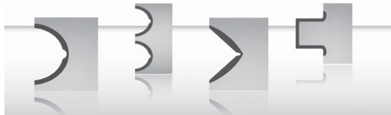
Induktionshärtung der Laufbahn · Inductive hardening of the raceway
